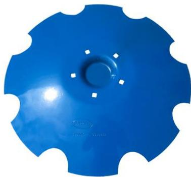
Диаметр 620мм, толщина 6мм, 5 квадратных отверстий 13x13 на расстоянии 158мм.
